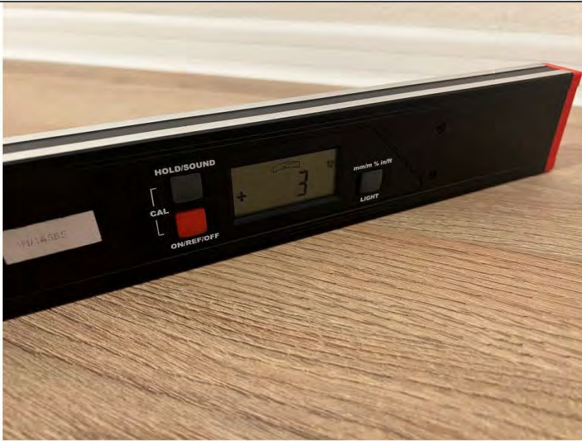
Фото №16. Измерение уровня напольного покрытия в спальне.
