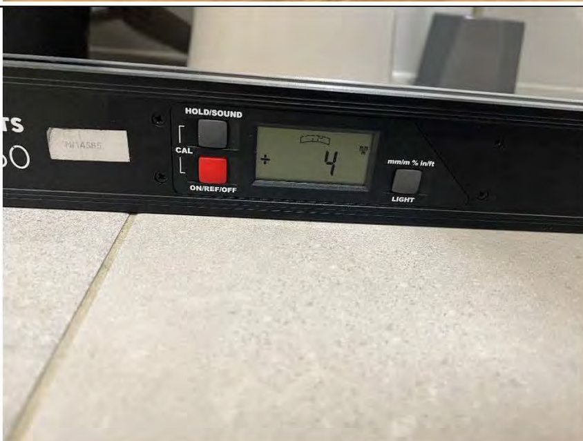
Фото №18. Измерение уровня напольного покрытия в ванной комнате.
